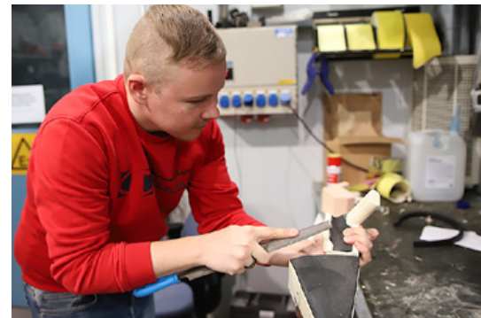
Le designer industriel Henri Hokkanen lime un modèle de conception d'accoudoir en plastique. Le studio de design utilise beaucoup de plastique, de bois et de pièces imprimées en 3D pour réaliser des modèles visuels de futurs tracteurs ou par exemple de cabines.
