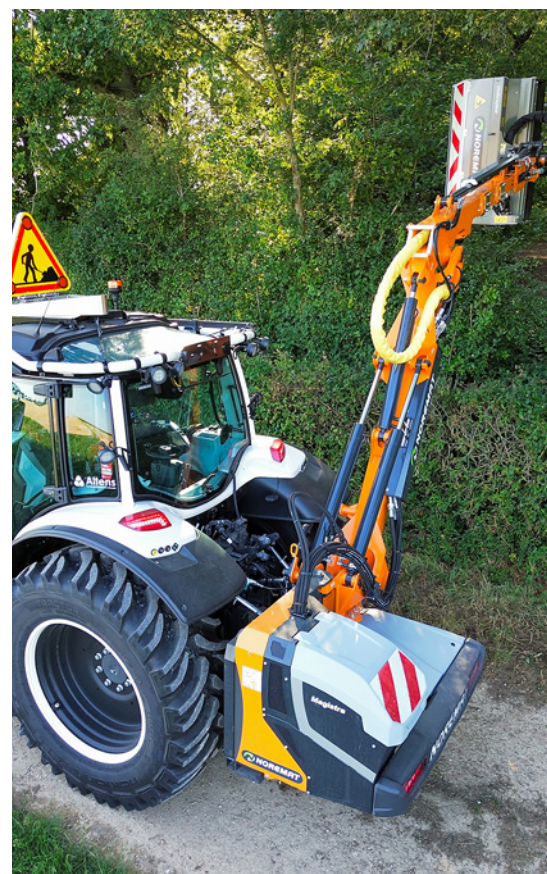
Une épareuse Noremat, directement montée d'usine.
