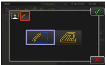
À partir de Wayline Assistant, il faut d'abord choisir si l'on souhaite créer des lignes de guidage segmentées (à gauche) ou une ligne de guidage Single Contour (à droite).
