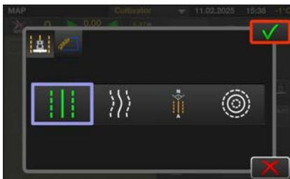
Ces quatre options de lignes de guidage sont en standard sur Valtra Guide. Dans l'angle supérieur gauche, un autre onglet est également visible seulement si Wayline Assistant est activé.
