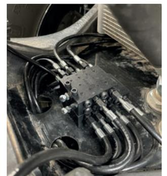
Système de lubrification centralisé
