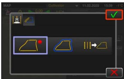
Si l'on souhaite créer des lignes de guidage segmentées, trois options sont disponibles. À gauche, les segments de ligne de guidage sont créés manuellement en conduisant et en les enregistrant. La deuxième option, au centre, permet de créer des segments en copiant à partir de la limite extérieure du champ. La troisième option, à droite, consiste à convertir les segments de lignes de guidage à partir des lignes de guidage traditionnelles.
