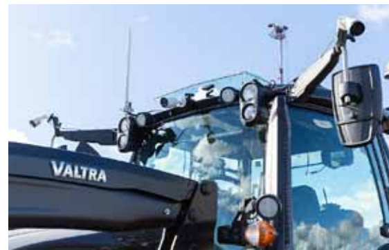
Des caméras situées à l'extérieur du tracteur télécommandé montrent au conducteur ce qui se passe autour du tracteur.
