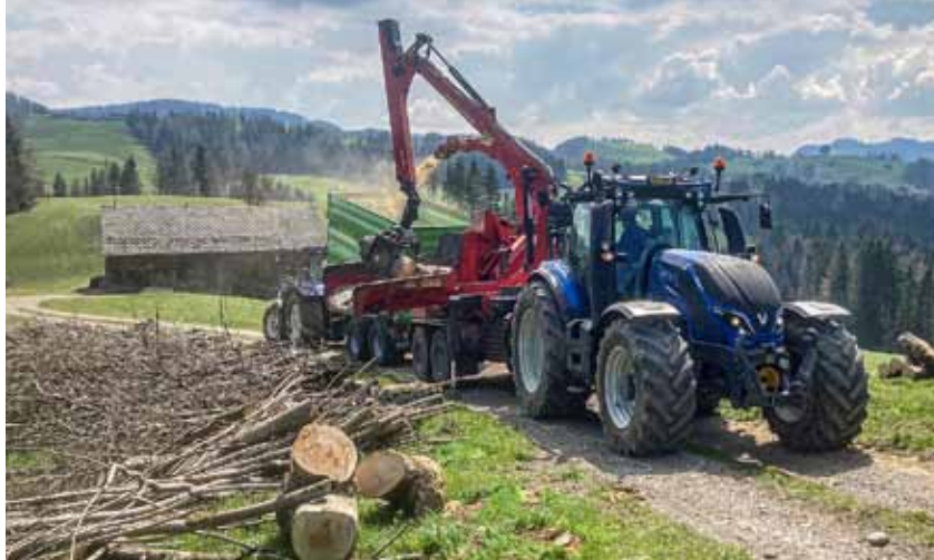
Traitement du bois sur place avec la broyeuse mobile.
