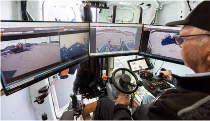
Ici, une camionnette abrite les commandes du tracteur. Le tracteur peut également être commandé à distance avec les commandes d'un autre tracteur ou, dans une mesure plus limitée, par une unité de commande séparée ressemblant à une tablette portable.
