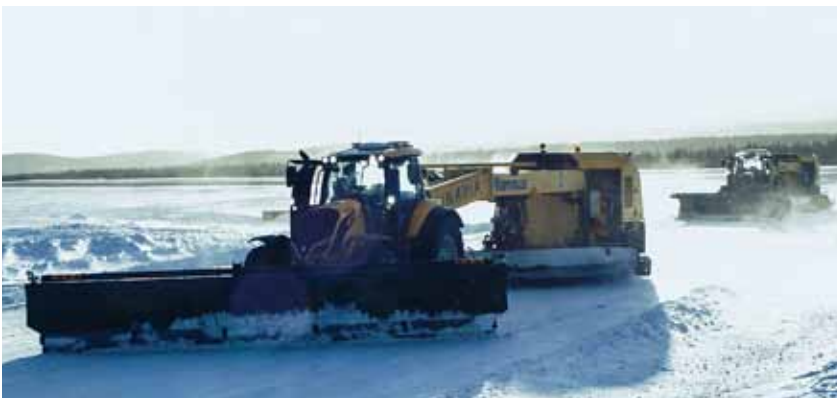
Ici, une camionnette abrite les commandes du tracteur. Le tracteur peut également être commandé à distance avec les commandes d'un autre tracteur ou, dans une mesure plus limitée, par une unité de commande séparée ressemblant à une tablette portable.
