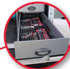
Les outils à main les plus courants se trouvent dans de longs tiroirs qui s'ouvrent sur la porte latérale. Il n'est donc pas nécessaire d'entrer et de sortir constamment du véhicule pour aller chercher des outils. Il suffit de les prendre de l'extérieur. Tous les outils ont leur propre place dans de la mousse ce qui permet de voir immédiatement s'il manque un outil.
