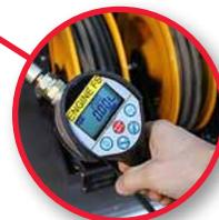
Le véhicule est équipé de réservoirs fixes avec 75 litres d'huile moteur FS, 150 litres d'huile XT60+ pour la transmission et 75 litres d'huile 80W-90 LS pour l'essieu avant. Les huiles usagées sont récupérées dans des fûts métalliques.
