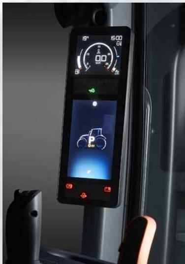
Sur les modèles HiTech et Active, les réglages du moteur, de la transmission, de l'hydraulique et les autres réglages du tracteur se font à partir du nouvel écran intelligent. Sur tous les modèles, l'écran permet de suivre les informations nécessaires au travail en plus des témoins lumineux et des informations de base du tableau de bord.
