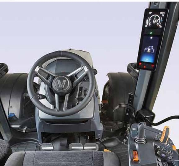
La cabine des Séries N et T est complètement nouvelle. Le tableau de bord a été déplacé de la colonne de direction vers le montant droit où il est bien visible. L'écran intelligent d'environ 15 x 40 cm est contrôlé sous le volant.
