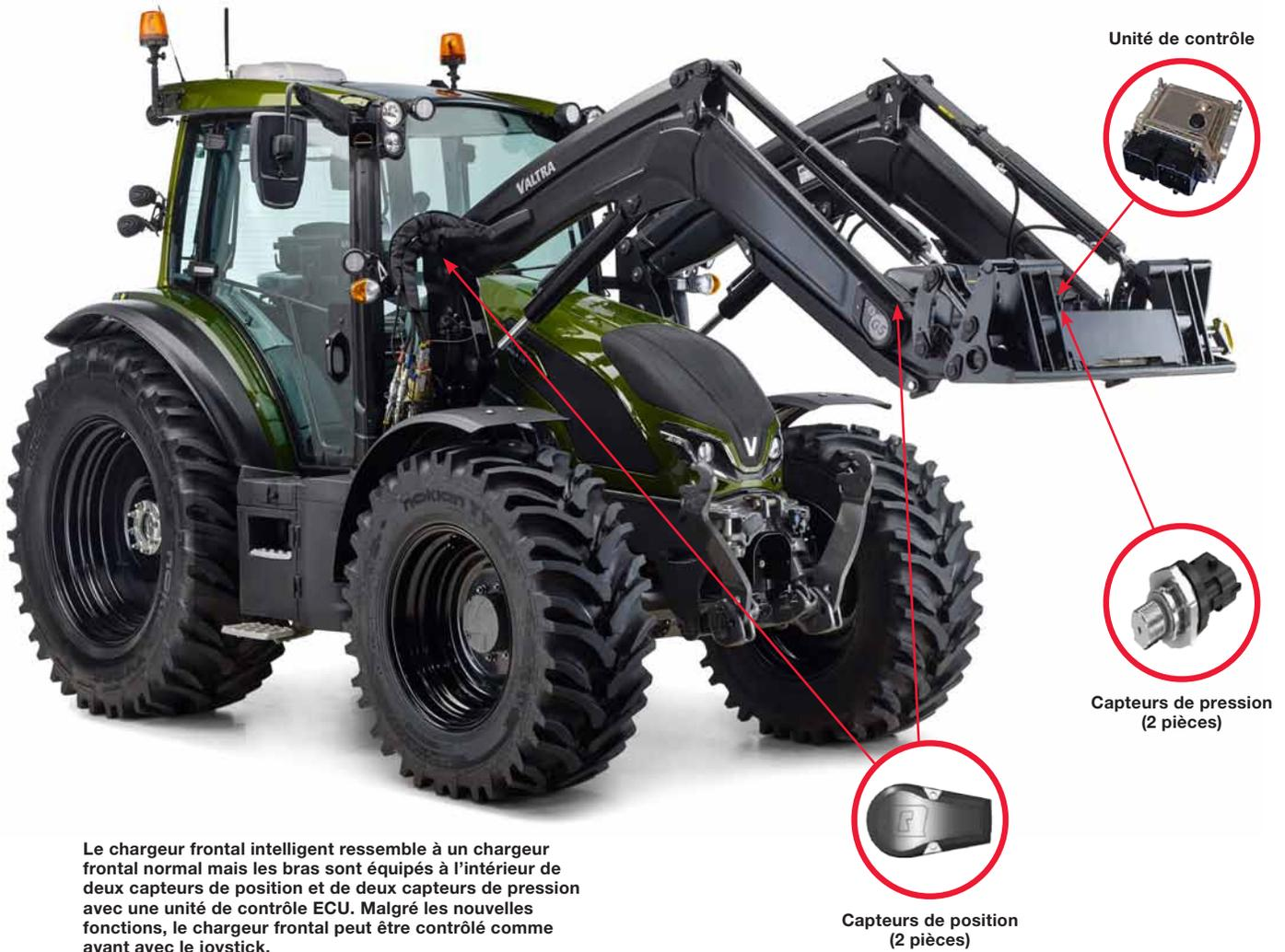
Le chargeur frontal intelligent ressemble à un chargeur frontal normal mais les bras sont équipés à l'intérieur de deux capteurs de position et de deux capteurs de pression avec une unité de contrôle ECU. Malgré les nouvelles fonctions, le chargeur frontal peut être contrôlé comme avant avec le joystick.
