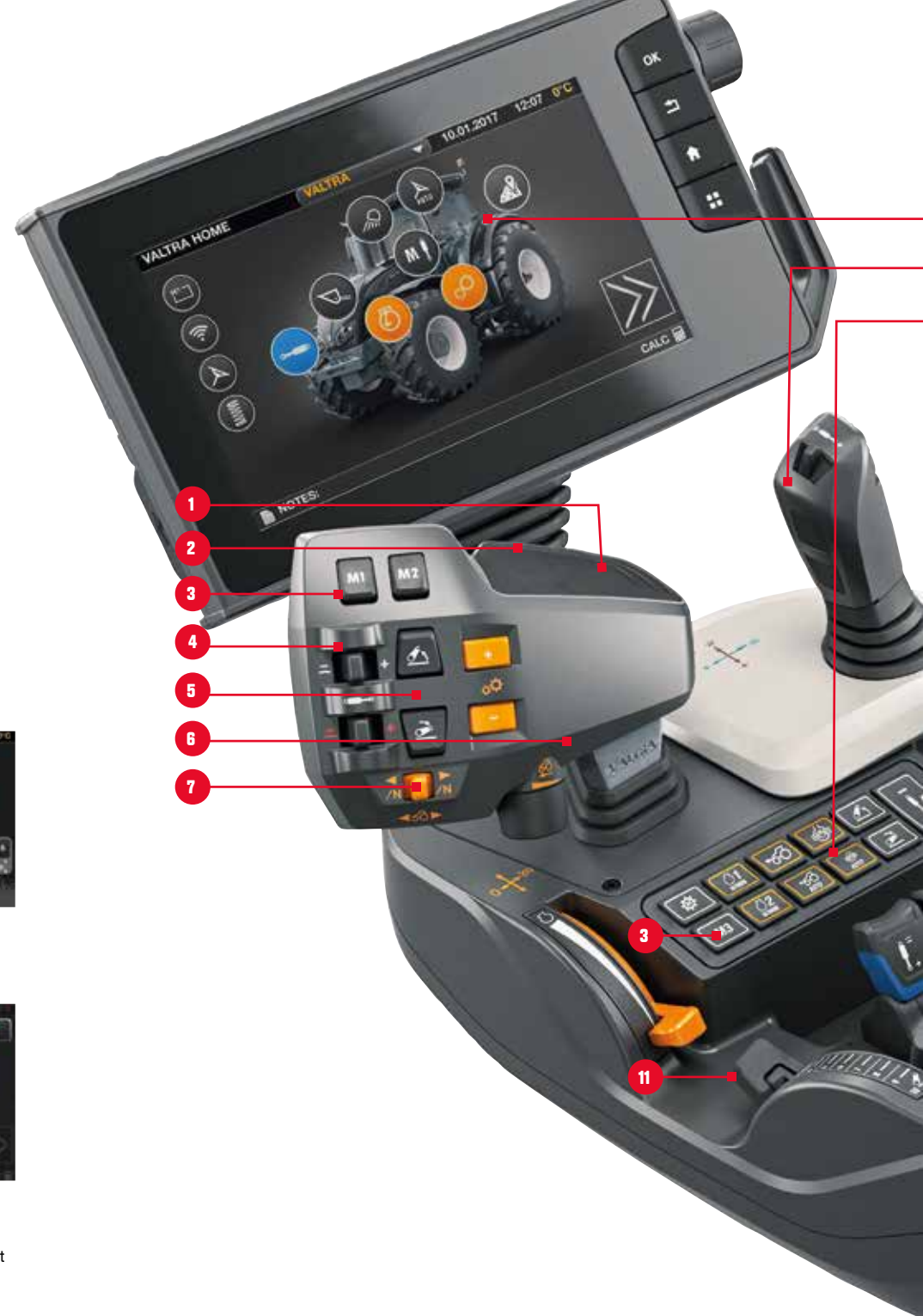
Profils pour les opérateurs et les outils qui peuvent être facilement modifiés à partir de n'importe quel menu d'écran. Tous les changements de réglages sont sauvegardés dans le profil sélectionné.
