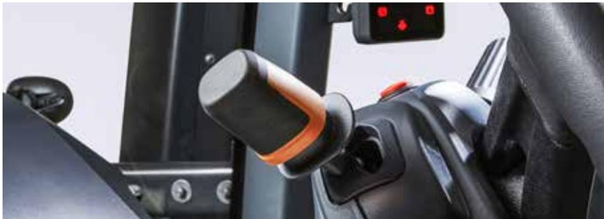
**Frein de parking intégré** / Le frein de parking entièrement intégré et facile à utiliser, réduit le stress et les mouvements non utiles pendant le chargement. Placé parfaitement derrière le volant, il est facile d'accès.
