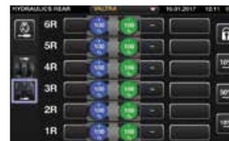
Vous pouvez attribuer une commande pour actionner une fonction hydraulique, y compris les distributeurs hydrauliques avant et arrière, les relevages avant et arrière et le chargeur frontal.
