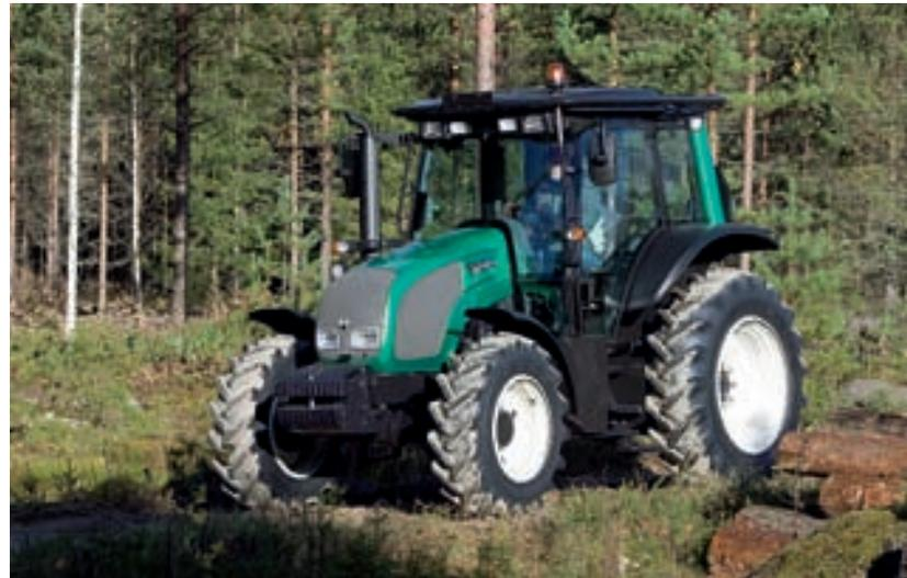
**Pour les travaux forestiers, les tracteurs peuvent également être équipés d'une cabine forestière avec une pédale d'accélérateur arrière et un réservoir de carburant protégé.**
