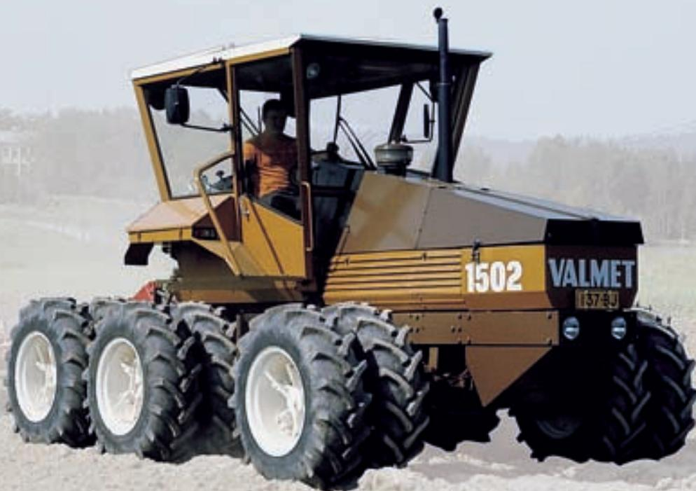
**Le Valmet 1502 était impressionnant. Le tracteur offrait des capacités de traction et des caractéristiques de direction améliorées avec un pont avant moteur. Les pneumatiques agricoles appropriés n'étant pas disponibles, le tracteur utilisait des roues doubles 13.6-24.**
