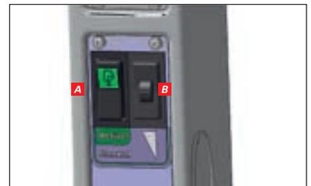
**La console de contrôle AutoComfort est située sur le pilier (B) droit de la cabine. Lorsque l'interrupteur est en position centrale, l'amortissement est automatique. Lorsqu'il est en position inférieure, le système est manuel et le degré d'amortissement peut être réglé par le bouton.**
