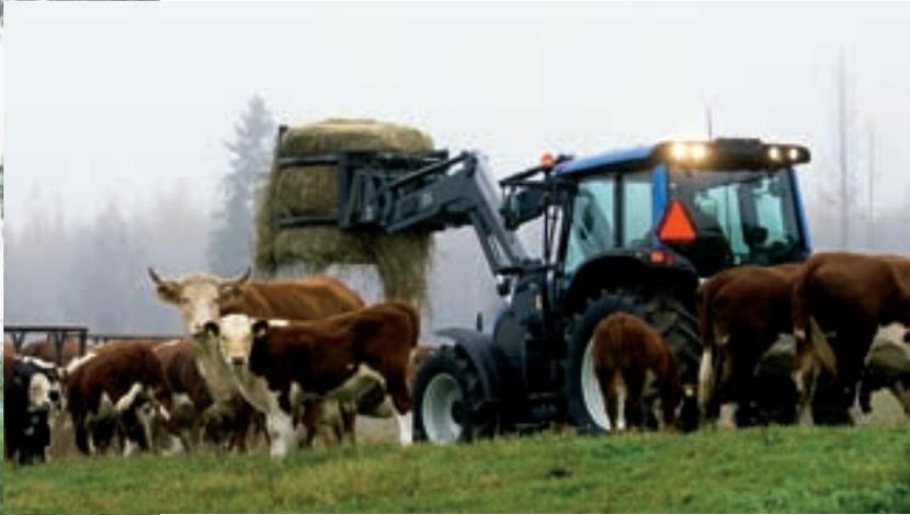
**Les nouveaux tracteurs de la série N sont les meilleurs pour les travaux avec chargeur frontal. La visibilité est parfaite, l'embrayage à turbine est précis, et le tracteur chargé par exemple d'une bale, est très équilibré grâce à son capot relativement léger.**
