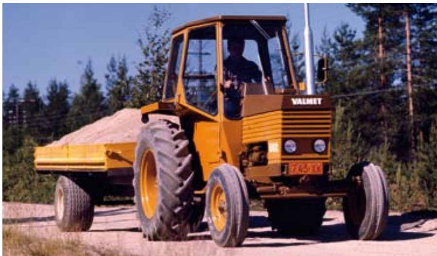
Le Valmet 502 se distinguait par son apparence face aux autres tracteurs de l'époque. Le moteur 310B Valmet 3 cylindres avait une cylindrée de 2,7 litres. Sa puissance s'élevait à 54 cv SAE/2 300 tr/mn. La boîte de vitesses partiellement synchronisée offrait six vitesses avant et deux vitesses arrière. Le poids du tracteur était de 2 495 kg.
