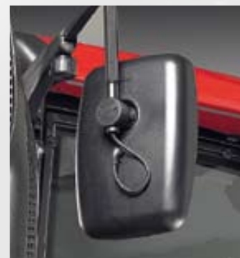
Les rétroviseurs électriques et chauffants améliorent la visibilité et la sécurité.
