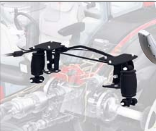
La suspension semi-active de la cabine Auto-Comfort est unique dans le monde des tracteurs. Elle a été récompensée au salon Agritechnica par la médaille d'argent de l'innovation.
