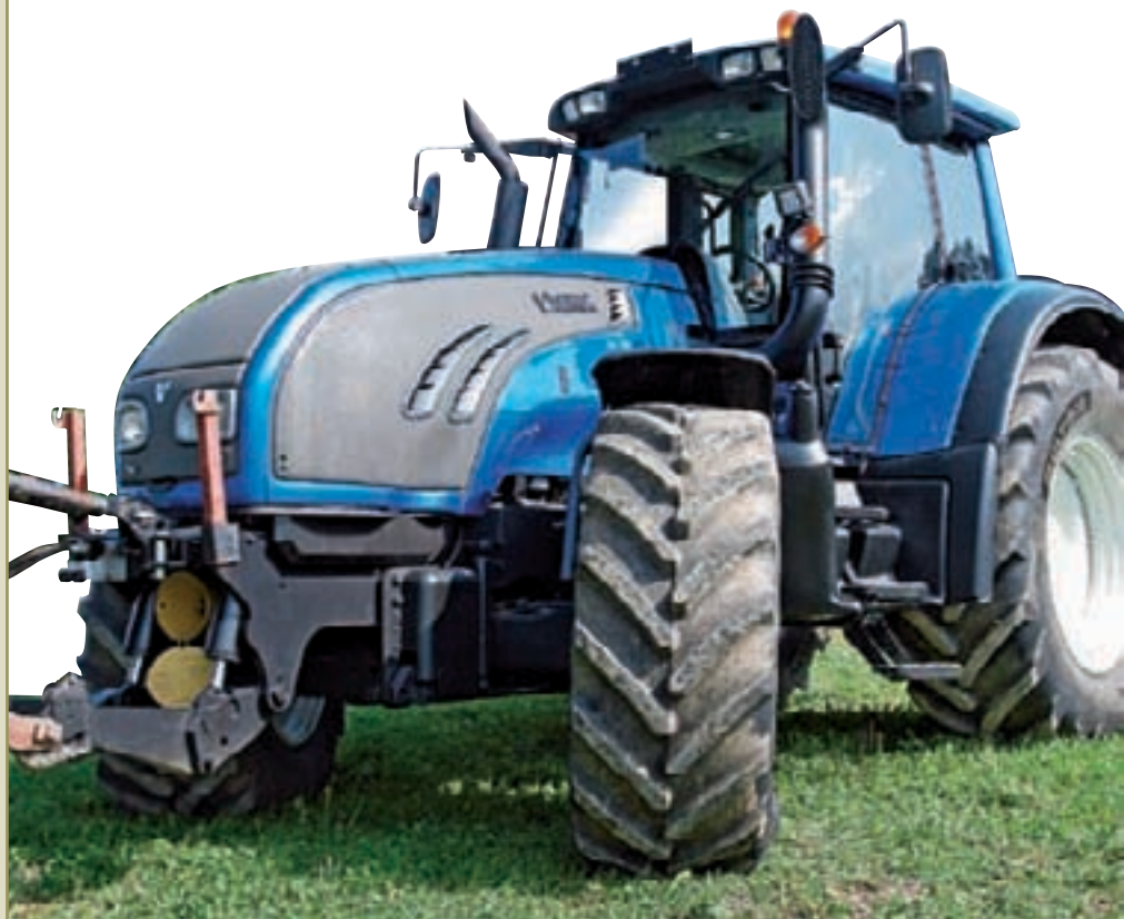
Le «T 162e Versu» dispose d'une boîte à cinq rapports sous charge innovante.
