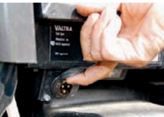
La prise pour le préchauffage du moteur se trouve sous la cabine.
