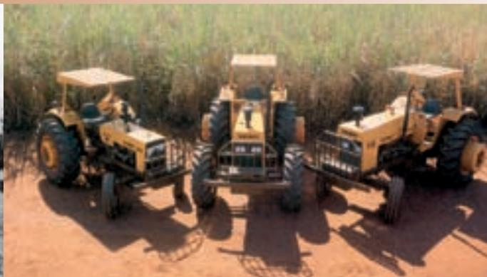
▲ La série "Alcool" de Valmet do Brasil se composait de trois modèles : le Valmet 88 quatre cylindres et les Valmet 118 et 118-4 six cylindres.
