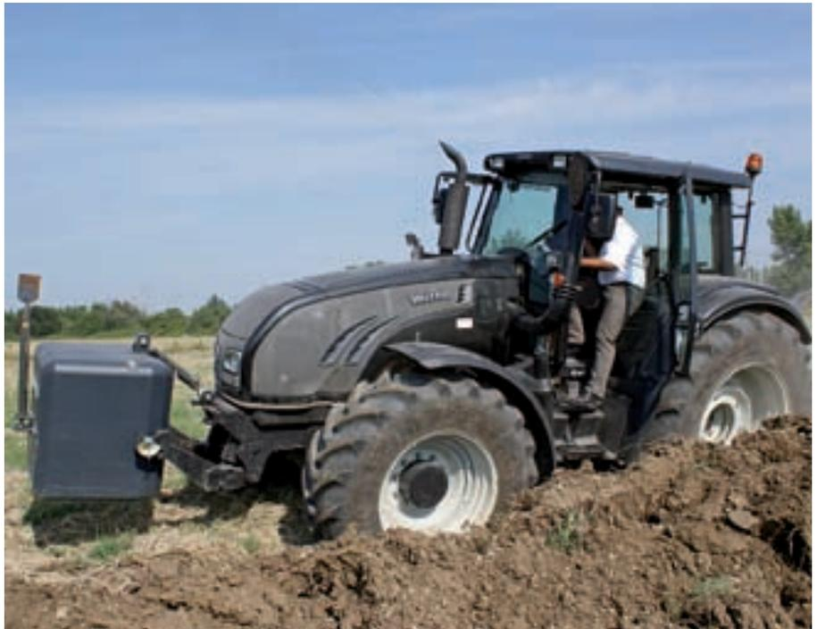
*Pour préparer le sol, une charrue « quart de tour » est utilisée pour une profondeur de labour entre 60 et 80 cm. Ici un T182 Direct en plein labour à 65 cm de profondeur.*
