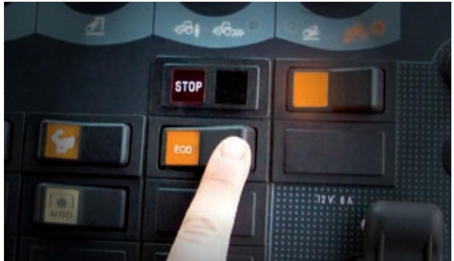
*Un simple interrupteur permet d'économiser de 10 à 15 % de carburant.*
