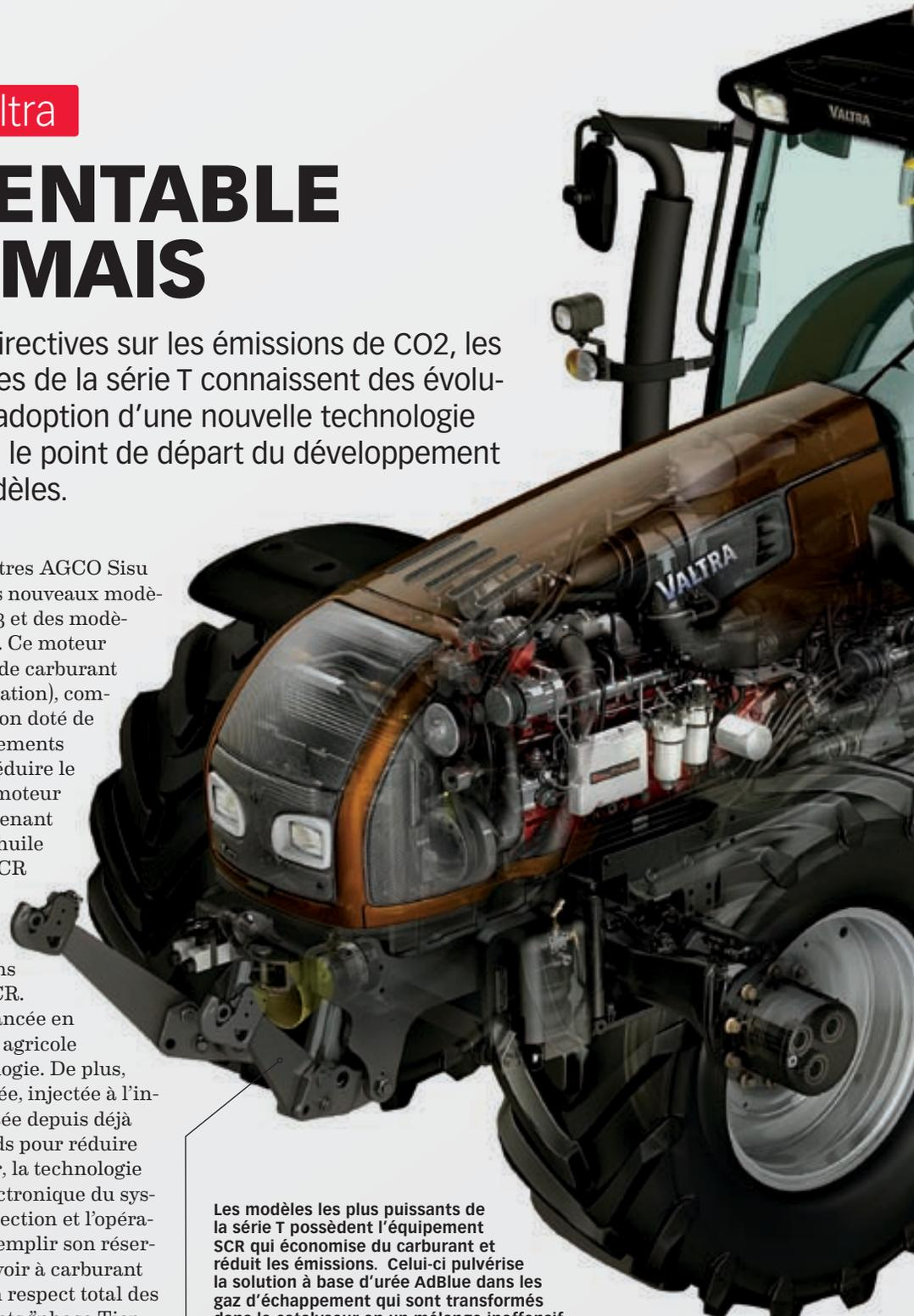
Les modèles les plus puissants de la série T possèdent l'équipement SCR qui économise du carburant et réduit les émissions. Celui-ci pulvérise la solution à base d'urée AdBlue dans les gaz d'échappement qui sont transformés dans le catalyseur en un mélange inoffensif d'azote et d'eau. Le moteur peut être parfaitement mis au point sans compromis car le système SCR traite les émissions de gaz d'échappement.
