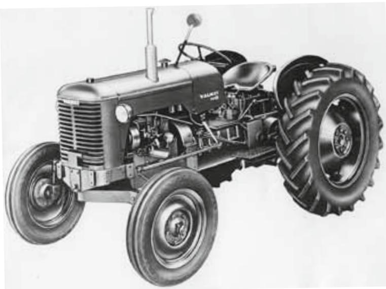
Le Valmet 359D était une version perfectionnée du Valmet 33D. Le châssis avant ou berceau était constitué d'une seule pièce en fonte, et le circuit hydraulique possédait sa propre huile avec son réservoir situé à côté du marchepied.
