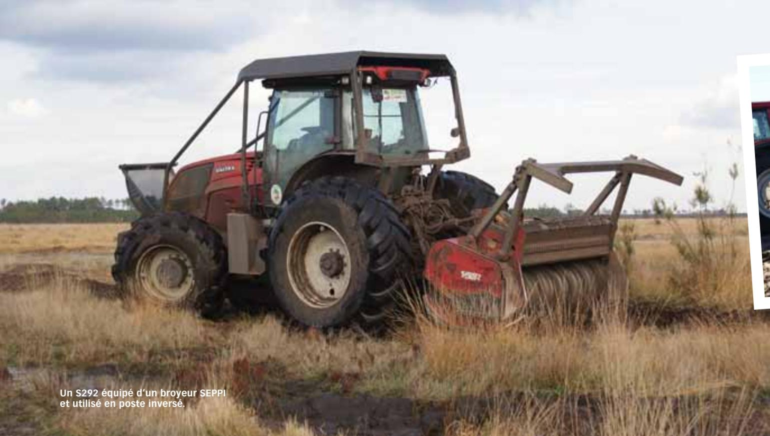
Un S292 équipé d'un broyeur SEPPi et utilisé en poste inversé.
