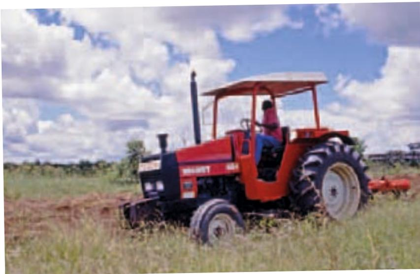
Le Valmet 604 était équipé d'un moteur 3 cylindres de 3,3 litres pour 61 chevaux. Au début, la transmission était basée sur une boîte de vitesses 6avt+2arr. En 1987, la boîte de vitesses a évolué avec 8avt+4arr ainsi que des réductions finales planétaires et des freins multidisques humides sont apparus.
