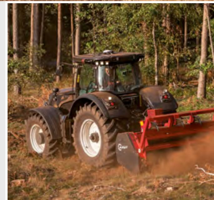
Le modèle le plus puissant de la nouvelle Série S offre une puissance jusqu'à 400 chevaux et un couple de 1 600 Nm avec turbo. Le moteur est équipé d'un double turbo et d'une soupape de décharge réglable électriquement.
