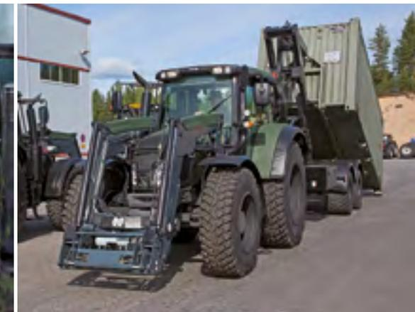
Les tracteurs sont équipés d'appareils à bras permettant de déplacer les conteneurs.
