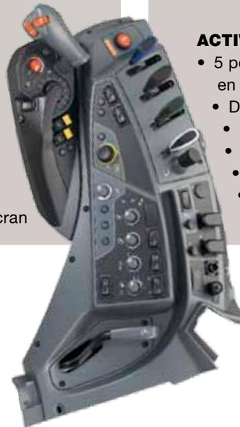
Les transmissions HiTech et Active peuvent être contrôlées alternativement par le Control Grip, sans l'accoudoir ARM. Une alternative simple, facile et économique.
