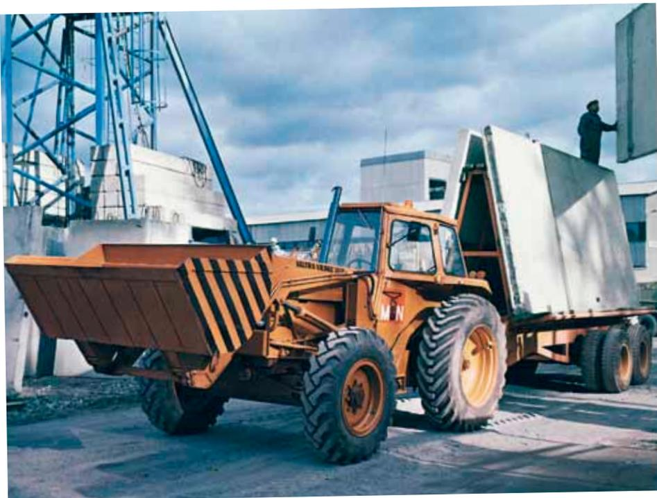
Le Valmet 1100-4 était en 1969 un tracteur à part : 4 roues motrices, un moteur quatre cylindres turbo pour une puissance de 115 chevaux.
