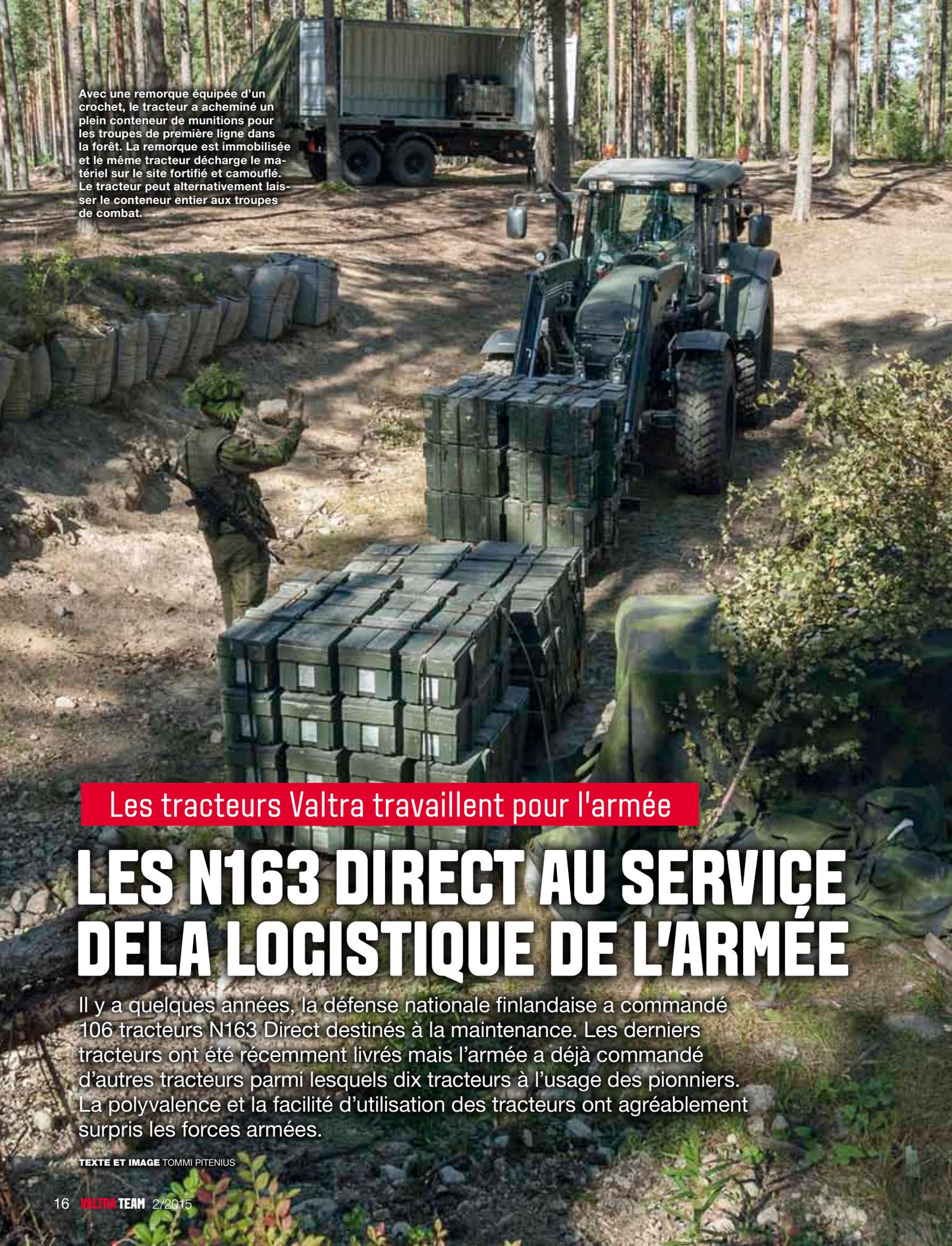
Avec une remorque équipée d'un crochet, le tracteur a acheminé un plein conteneur de munitions pour les troupes de première ligne dans la forêt. La remorque est immobilisée et le même tracteur décharge le matériel sur le site fortifié et camouflé. Le tracteur peut alternativement laisser le conteneur entier aux troupes de combat.
