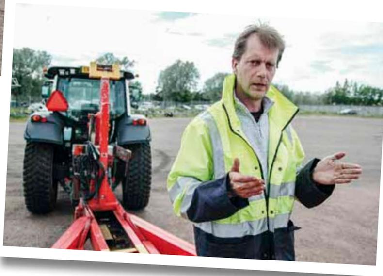
Ari Jaakkola, conducteur de tracteur au Club Nautique de Kotka présente le principe du fonctionnement hydraulique de la remorque à bateaux. La quille du bateau repose sur une surface mobile et quatre protections rembourrées serrent la coque du bateau.
