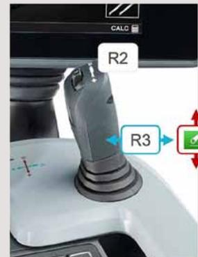
**1** Avez-vous besoin du système automatique U-Pilot ? Sa programmation est facile. Vous pouvez programmer de nombreuses actions successives à réaliser soit dans un intervalle de temps précis, soit sur un trajet défini pour le tracteur. Par exemple pour le labour, à l'arrivée en bout de champ, le bouton de mémoire M1 permet en une tape, de désengager le pont avant, le régulateur de vitesse et le différentiel, de lever et retourner la charrue. À la sortie du bout de champ, le bouton
