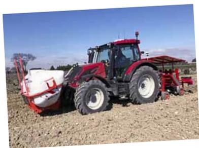
Plantation des vignes avec une planteuse de vigne fabriquée par leurs soins, autoguidée RTK, attelée sur un tracteur N134 Direct SmartTouch autoguidé également en RTK pour une précision optimale !
