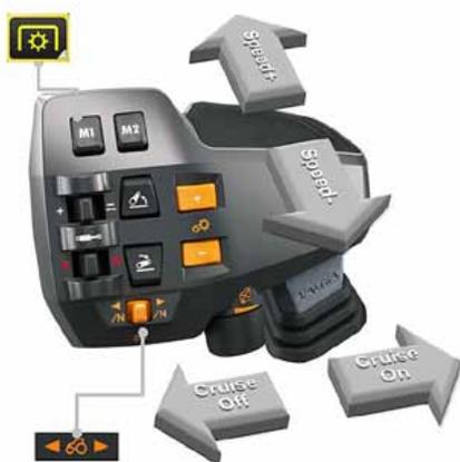
bon régime avec l'accélérateur manuel ou la pédale. Seconde caractéristique intéressante, l'engagement automatique de la prise de force permet de décider le démarrage ou l'arrêt de la PDF lorsque le relevage arrière est dans une position donnée. Pour le déneigement notamment, la PDF s'arrête toujours lorsque le relevage est monté au-dessus d'une limite donnée et démarre lorsqu'il est baissé en dessous de la même limite ou d'une autre limite.
