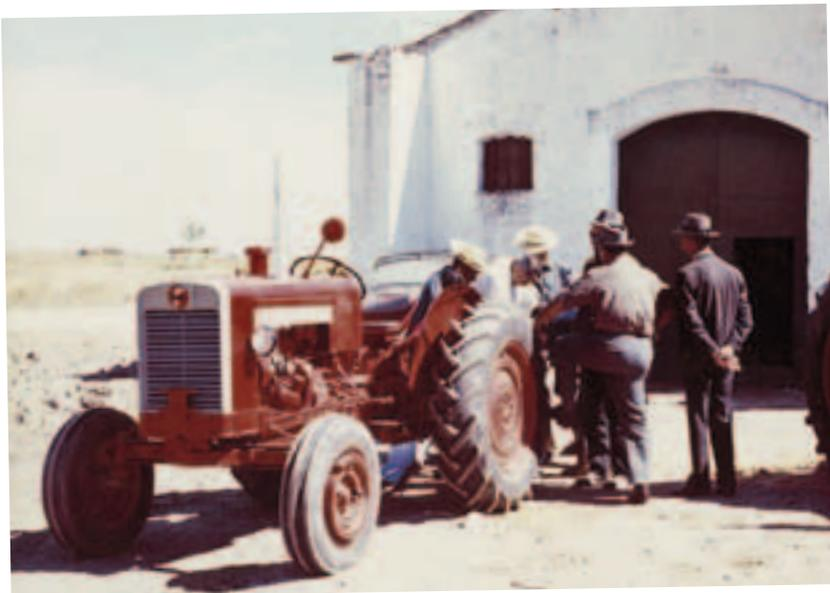
Le modèle FAP 361 D et les fermiers portugais. Les caractéristiques techniques étaient presque identiques à celles du modèle finlandais, mais la dureté de la terre au Portugal a rendu nécessaire l'utilisation de masses d'alourdissement sur les roues avant et arrière. Le moteur trois cylindres du Valmet 361 D avait une puissance de 46 chevaux, avec six vitesses avant et deux arrière.
