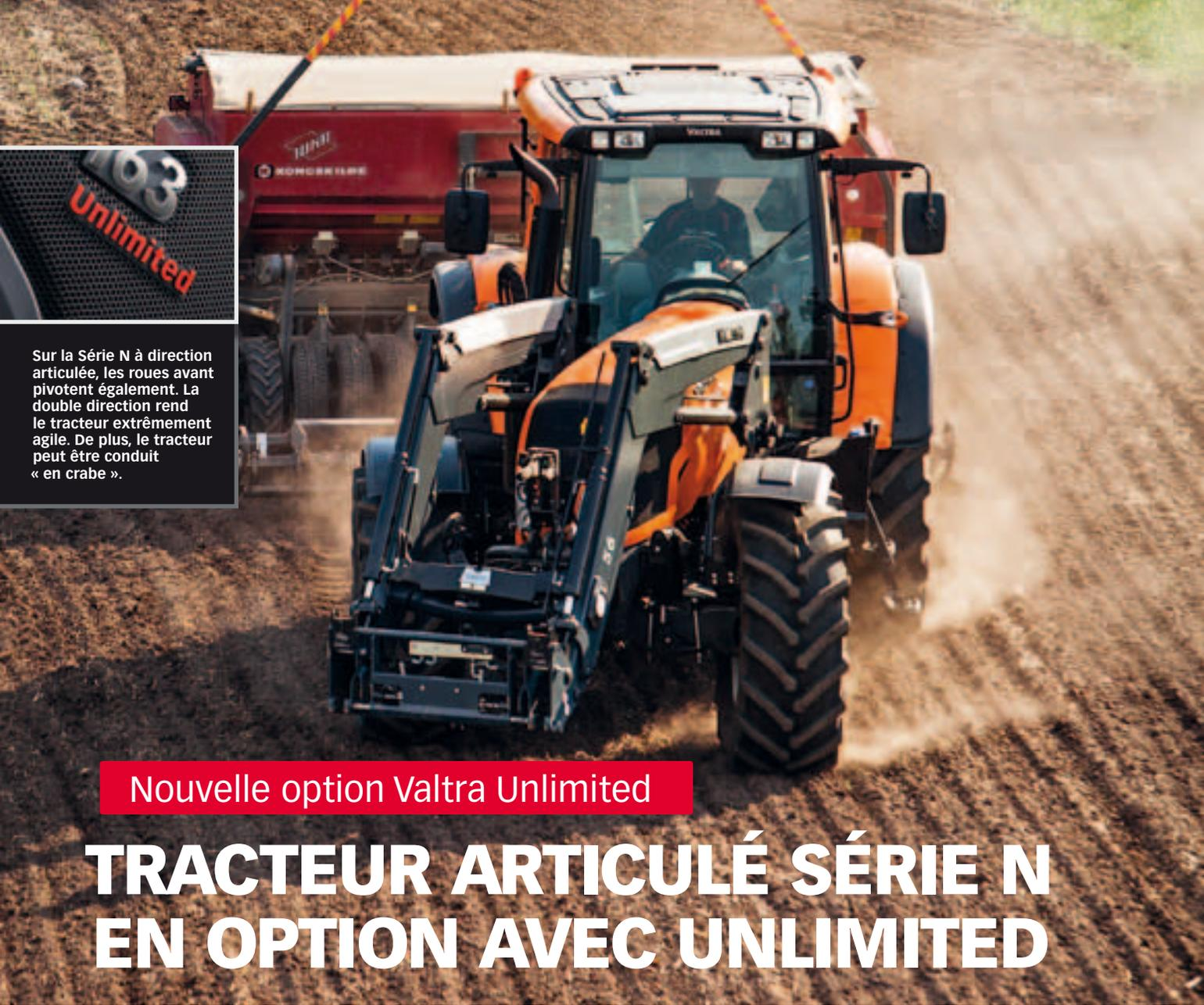
Sur la Série N à direction articulée, les roues avant pivotent également. La double direction rend le tracteur extrêmement agile. De plus, le tracteur peut être conduit « en crabe ».
