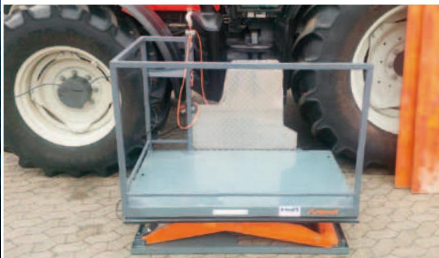
Simple et efficace : la plate-forme lvatrice pour motos aprs conversion.
