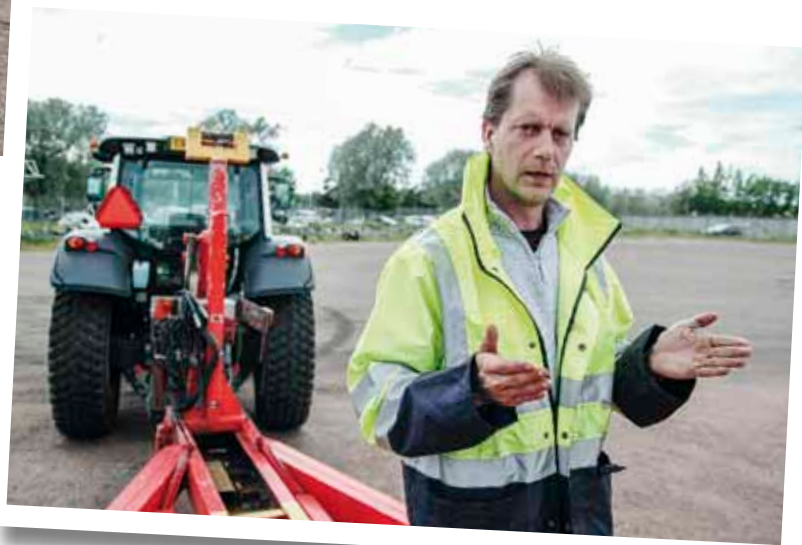
Ari Jaakkola, conducteur de tracteur au Club Nautique de Kotka présente le principe du fonctionnement hydraulique de la remorque à bateaux. La quille du bateau repose sur une surface mobile et quatre protections rembourrées serrent la coque du bateau.
