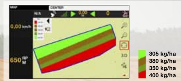
La modulation de dose d'intrants Variable Rate Control permet notamment d'apporter avec précision la bonne quantité d'engrais nécessaire à différents endroits d'une même parcelle.
