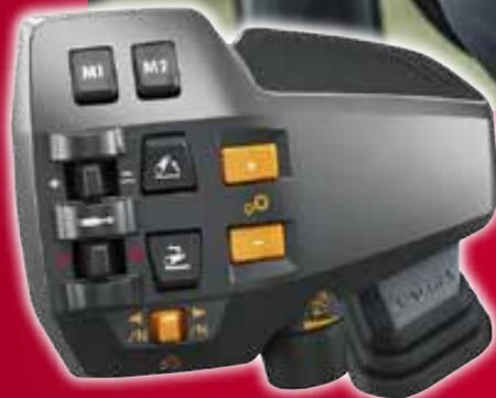
**Conduite automatique avec le levier multifonctions :** vous contrôlez la vitesse du tracteur avec le levier multifonctions, le tracteur sélectionne le rapport et le régime approprié.
