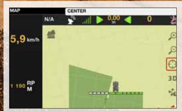
Section Control ouvre et ferme par exemple les sections de pulvérisation en fonction du besoin. Il permet une pulvérisation de précision sur les champs de forme irrégulière.
