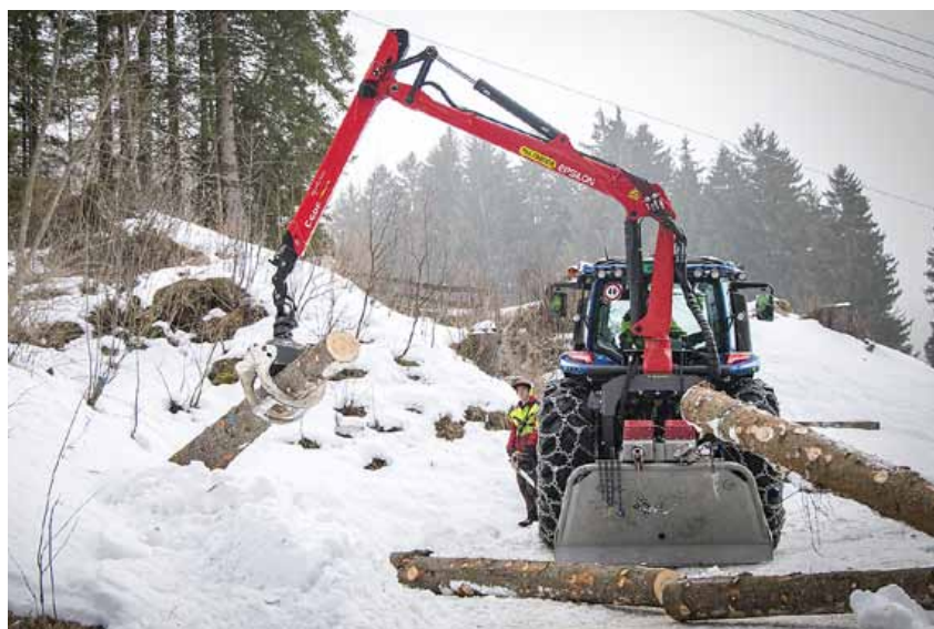
La grue démontable est un outil précieux en forêt. Elle facilite la tâche quotidienne et assure la sécurité des travailleurs forestiers.
