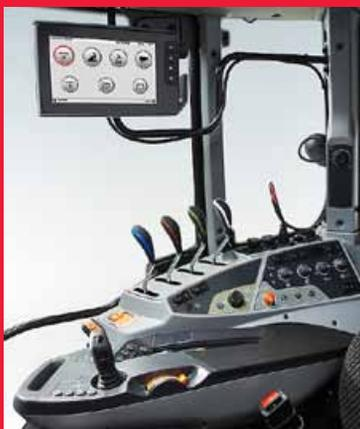
Sur la gauche: Sur les modèles HiTech et Active des Séries N et T, l'écran correspondant aux modèles SmartTouch est maintenant disponible. Cet écran permet d'utiliser les caractéristiques de l'agriculture de précision comme AutoGuide.
