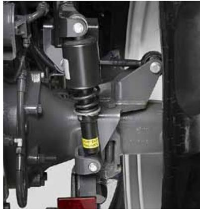
La suspension mécanique de la cabine est réglable, elle est stabilisée par deux barres Panhard.
