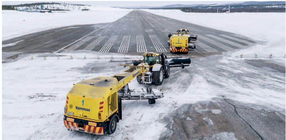
Le système automatique Valtra Guide se révèle même avec chauffeur, très utile pour le déneigement de l'aéroport. Les lignes de conduite enregistrées montrent les bordures et le milieu des pistes d'atterrissage bien que celles-ci soient enneigées. La gestion des tronçons associée au GPS permet également de répandre précisément la quantité suffisante d'antigel, ce qui économise de l'argent et épargne l'environnement.
