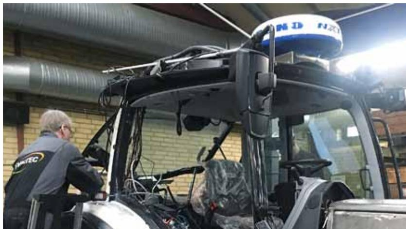
La Valtra N154 est une machine polyvalente pouvant être équipée d'une large gamme d'outils, comprenant un radar maritime, une caméra infrarouge de recherche de chaleur et un projecteur de recherche.
