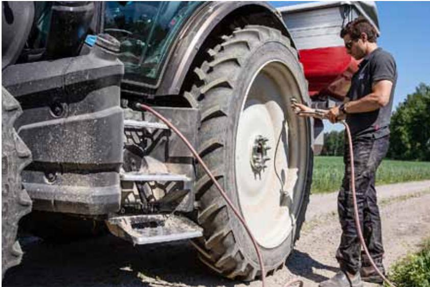
Sur la nouvelle Série G, il est possible d'obtenir un raccord de pression situé au niveau du marche-pied de la cabine pour faciliter notamment le réglage de la pression des pneumatiques.
