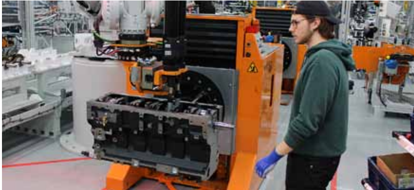
Assisté d'un robot industriel, le mécanicien Julius Salmela installe un vilebrequin sur un moteur six cylindres.
